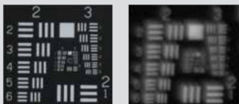
圖 12.6a: USAF 1951 範例：已重新定位的圖像的中心和邊角處，使得最佳焦點僅位於測試板中間。
