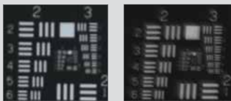
圖 12.6b: 在整個視場內具有平衡焦點的圖像中心和邊角處。
