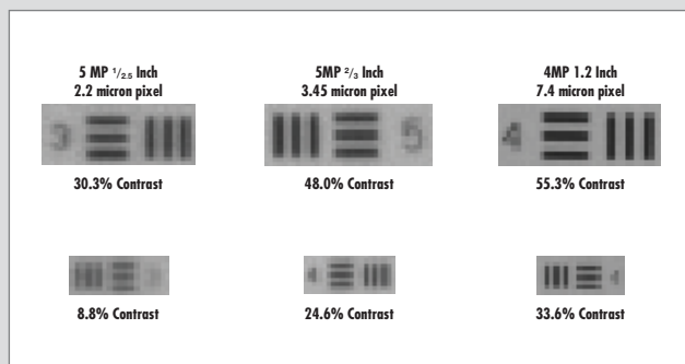
圖 6.9: 採用相同的鏡頭和照明條件，使用三種不同像素尺寸的相機傳感器拍攝的圖像。上方圖像每個特徵占四個像素，下方圖像每個特徵占兩個像素。
