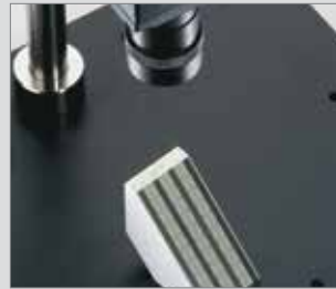
圖 12.11: 景深測試板應與鏡頭呈 45° 夾角。
