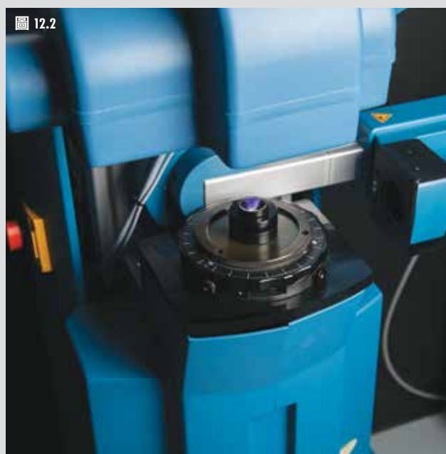
圖 12.2: 以市售 Trioptics 品牌的 MTF 測試站測試成像鏡頭。
